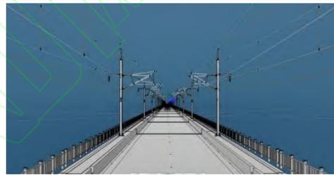
图 3 接触网参数化模型
