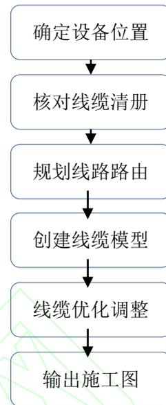
图 5 线缆排布优化流程
